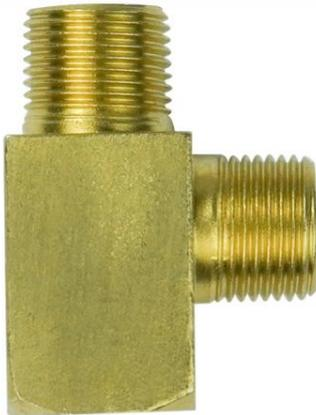
Raccord en T au pas gaz. Ce raccord est idéale pour effectuer différents montage HP. Ce raccord sur la partie mâle est équipé d'un cône de 60° pour l'étanchéité parfaite du flexible HP qui est raccordé.
